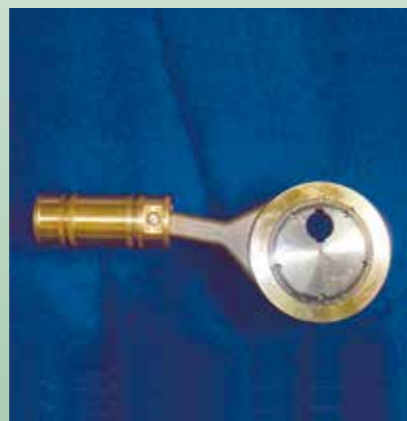
Hardened steel. Bronze rod and piston. Коленчатый вал из нержавеющей стали. Шатун и поршень из бронзы.
